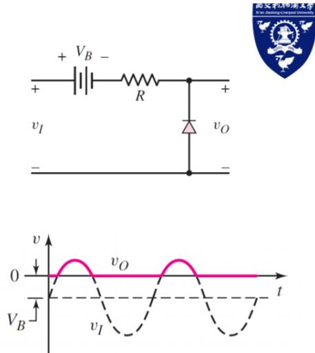
削波其实就是偏移了的整流。本来，交流电里加个二极管，正通反截，电流只剩下一个方向，所以叫整流。现在加上一个直流电源，相当于附上一个电压，于是正通反截的位置从0变到了  $V_B$  处，此时波就被“削”了，也叫限幅。所以最简单的二极管整流就是把某一方向的电流削没了。在 V-t 图上，这种模型里的直流电源效果就是：
