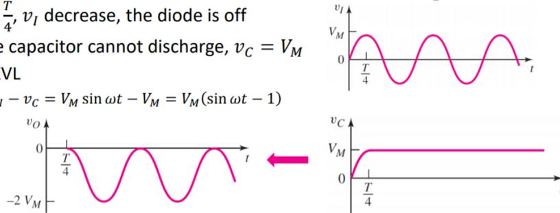
利用二极管单向导通的性质配合其他元件总可以有各种操作,比如上图用二极管单向导通的性质和电容打了一波配合锁死了电压 $V_M$ , 做到了钳位电路的效果。
